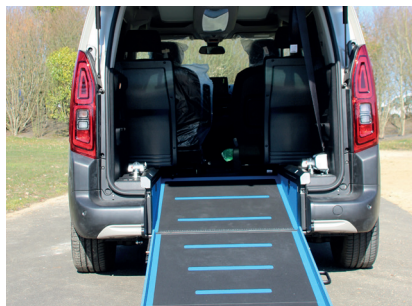
Large décaissement de la partie arrière recouvert d'antidérapant et insonorisé
