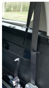
Sécurité de la personne transportée par une ceinture 3 points à enrouleur.
